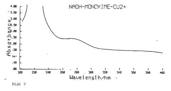
NaOH:  $4 \times 10^{-9}$  M, 10 mL 2.3-Butanedion monosime :  $2 \times 10^{-1}$  M, 10 mL Cu(NO<sub>2</sub>):  $1 \times 10^{-9}$  M, 10 mL Dis. H-O: 30 mL
